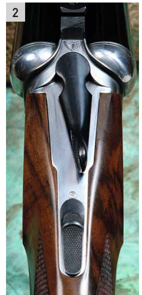
2. La codetta di bascula è di tipo tradizionale. In evidenza la chiave di apertura, la sicura a cursore e i rilievi di contorno dei seni, molto razionali e lineari.
