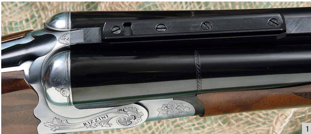
1. All'estremità posteriore della bindella c'è la slitta a coda di rondine per l'installazione di ottiche di puntamento.
